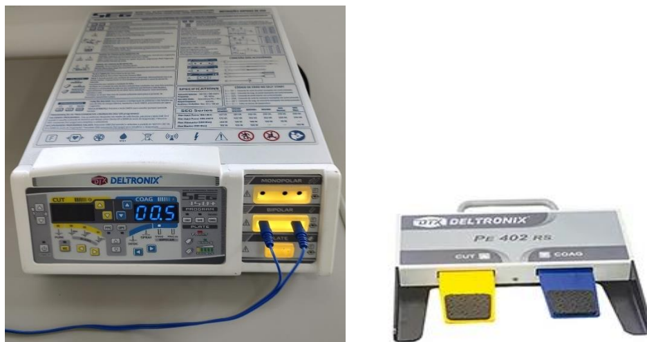
Figura 7. Fonte eletrocirúrgica convencional e pedal, compatíveis com o Eletrodo Bipolar AF.
