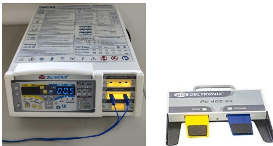
Figura 10 - Fonte eletro cirúrgica convencional e pedal, compatíveis com o Eletrodo Flexível Bipolar ORTHOFLEX
